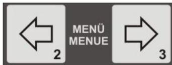
Premendo contemporaneamente i tasti 2 e 3 si naviga sul display alla schermata inizia con l'ampiezza di vibrazione (velocità di trasporto).
