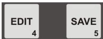
Premendo contemporaneamente i tasti 4 e 5 viene visualizzata sul display la versione del firmware.
